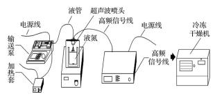
图 1 超声喷雾-冷冻干燥装置
